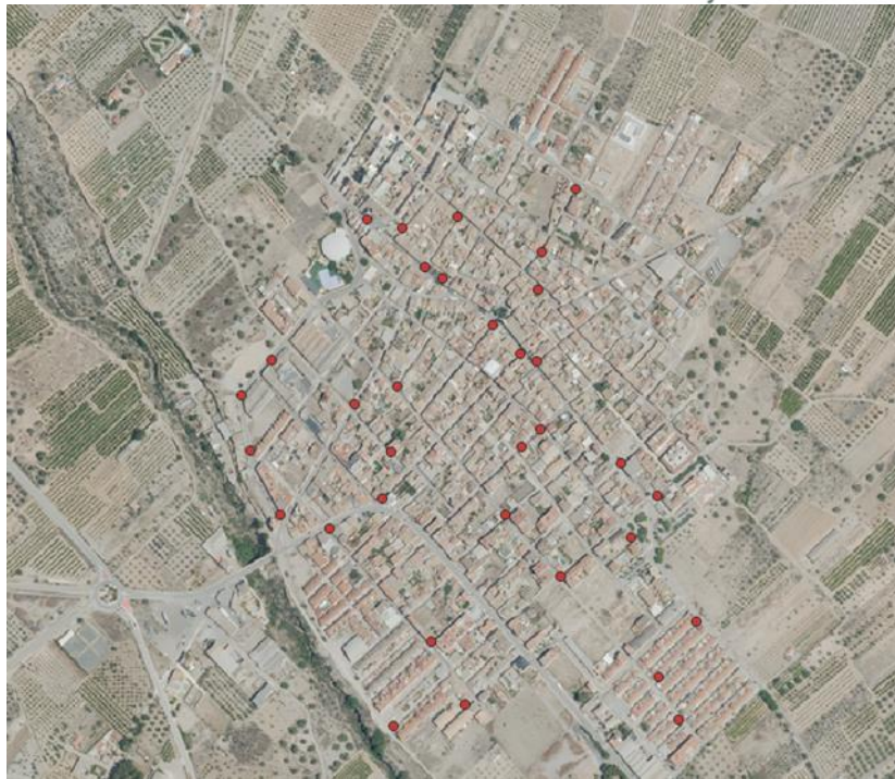
Figura 36: Hidrantes y bocas de riego presentes en el núcleo urbano de Casinos. Fuente: Oficina técnica del Ayuntamiento de Casinos.
