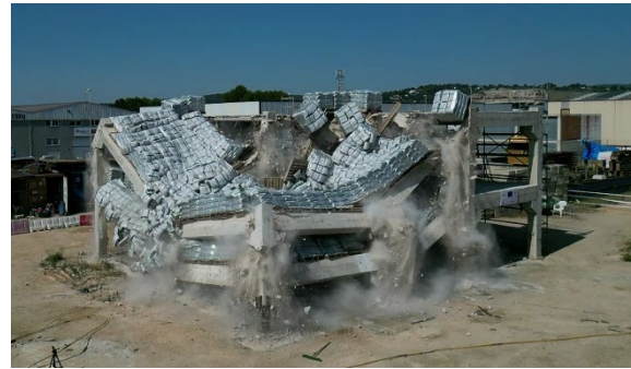
Figura 4. Evolución de los estados de daño del espécimen del edificio durante la Fase 2.
