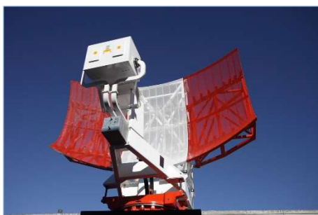
Fig. 7.3. Radar Primario de Vigilancia
