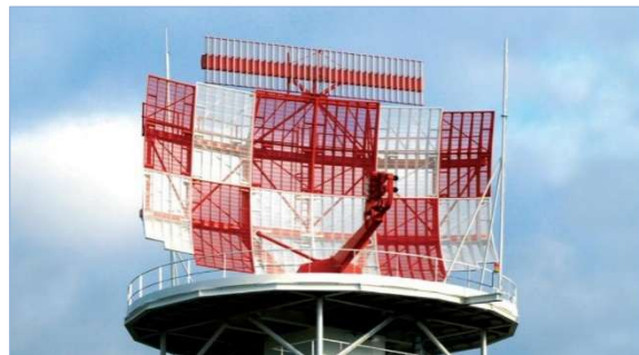
Fig. 7.8. Radar secundario montado en conjunto con el radar primario.
