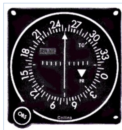
Fig. 3.16. HSI, Horizontal Situation Indicator. Indicador de desviación de curso
