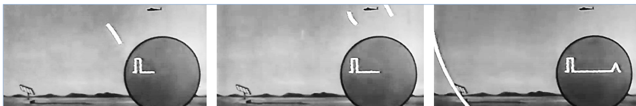
Fig. 7.5. Radar primario, pulso emitido y eco en pantalla.
