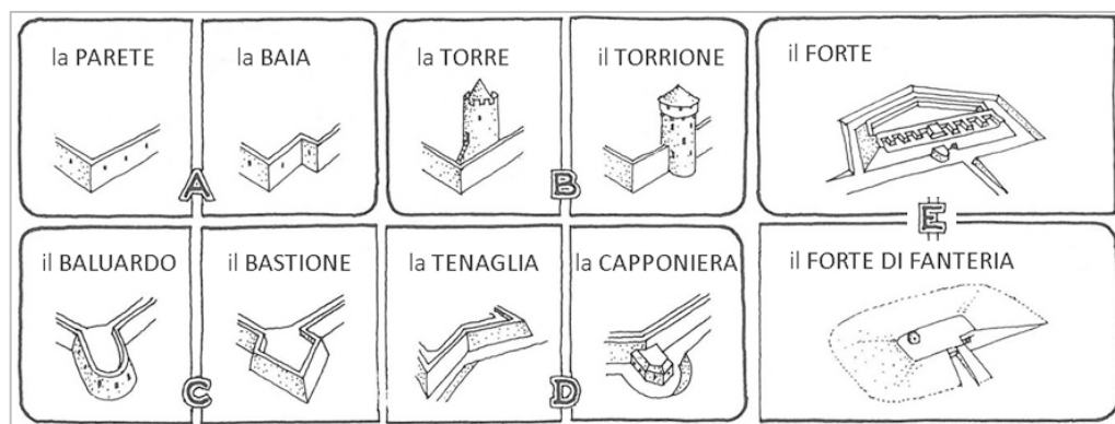
Fig. 1 - I principali elementi di difesa. A – la parete e la baia – le opere di difesa tipici dell’Alto Medioevo; B – la torre e il torrione - il Medioevo; C – il baluardo e il bastione – caratteristici per i tempi Moderni (principalmente XVI e XVII secolo); D – la tenaglia e la capponiera – XVIII e XIX secolo; E – il forte e il forte di fanteria - fine del XIX e XX secolo/e di questo secolo (J. Bogdanowski, 1996, tav. 4).
