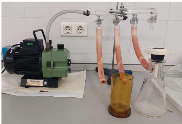
Figura 33. Equipo de filtración. Fuente: Elaboración propia.
