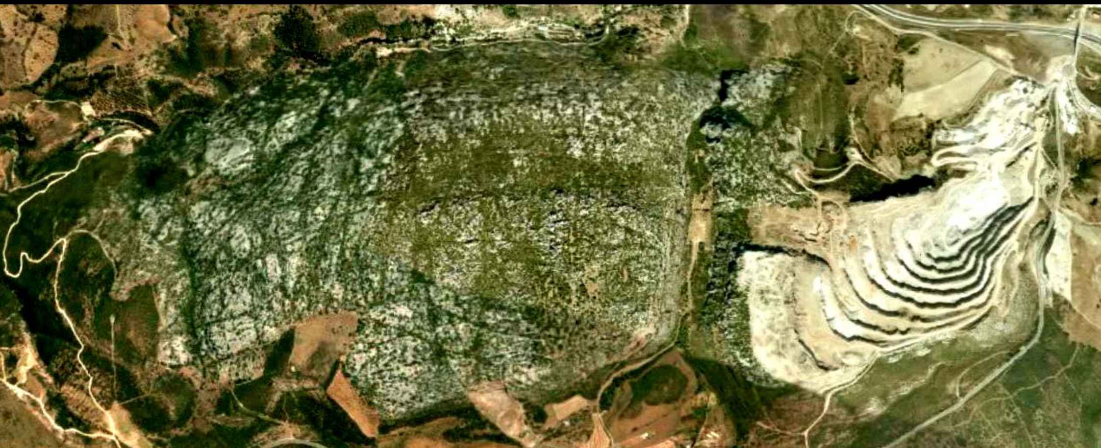
Familias de discontinuidades en las rocas carbonatadas del Jurásico al S de Casares. A derecha cantera. N a la Izq. Hoja de Jimena de La Frontera.
