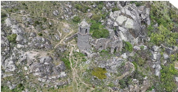
Figura 7. Nube de puntos generada con el software fotogramétrico de código abierto GRAPHOS.
