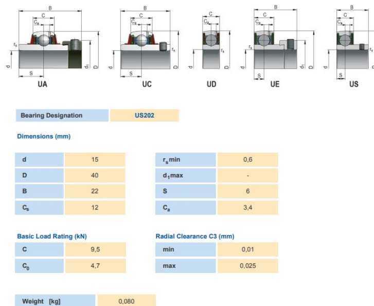
Figura 1.9.3.1 - información del rodamiento
