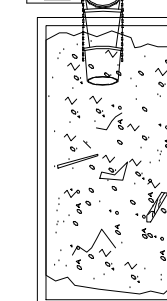
CONDOLA, BAJANTE Y BOCA DE VERTIDOS DE ESCOMBROS
