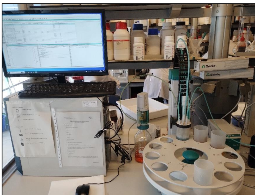
Figura 31. Obtención y lectura de los resultados de DQO
