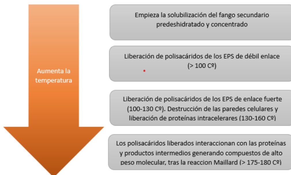
Figura 15. Esquema teórico de la influencia del aumento de la temperatura en la HT
