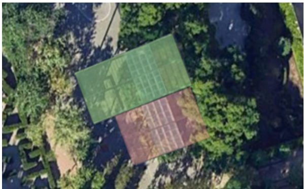
Figura 27: Zonas de la instalación fotovoltaica.
