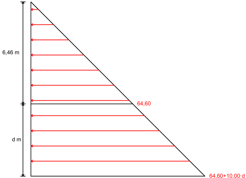
Figura 12. Empujes unitarios intersticiales en intradós en KN/m 2 (Fuente: elaboración propia).
