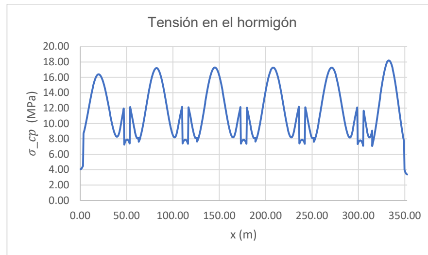
Figura 6.21 Ley de tensiones \sigma_{cp}(x)
