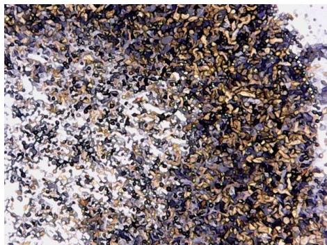
Fig 7. Partículas de nitruro e hidruro de titanio generadas con N90H10 (Rodríguez, B. 2023).
