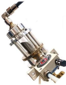
Fig 4. Suministrador de polvo de fabricación propia (Ruiz, A. 2024)
