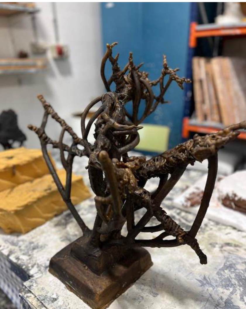
(Fig. 45) Árbol de colada bañada en goma laca, segundo baño.
