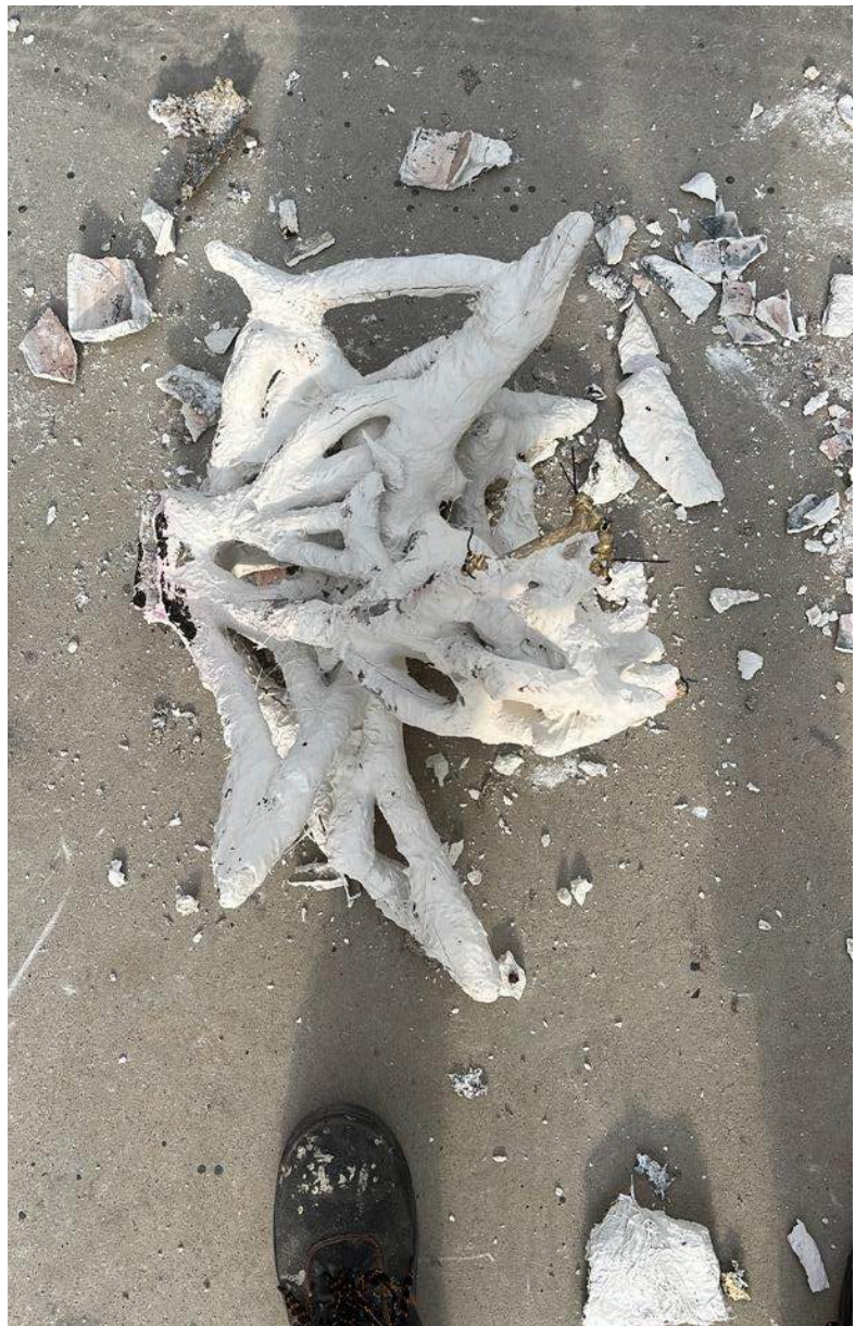
(Fig. 52) Pieza después de recibir el latón en su interior.
