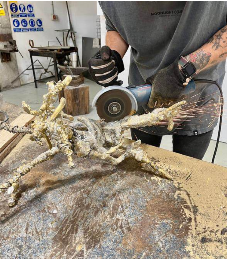
(Fig. 55) Cortando los bebederos.
