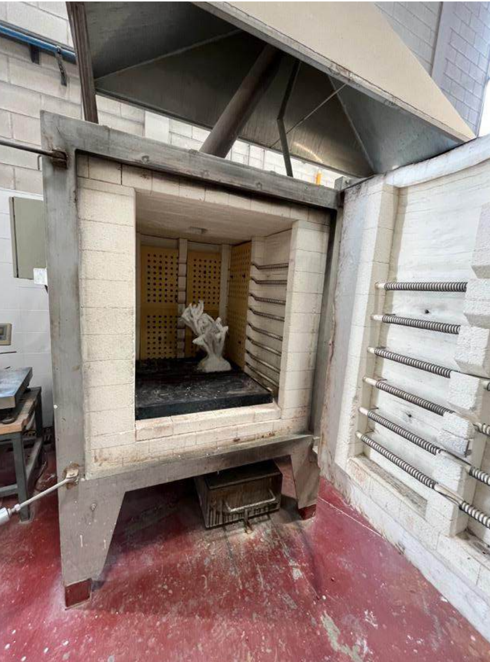
(Fig. 47) Pieza en el horno para eliminar la cera interior.
