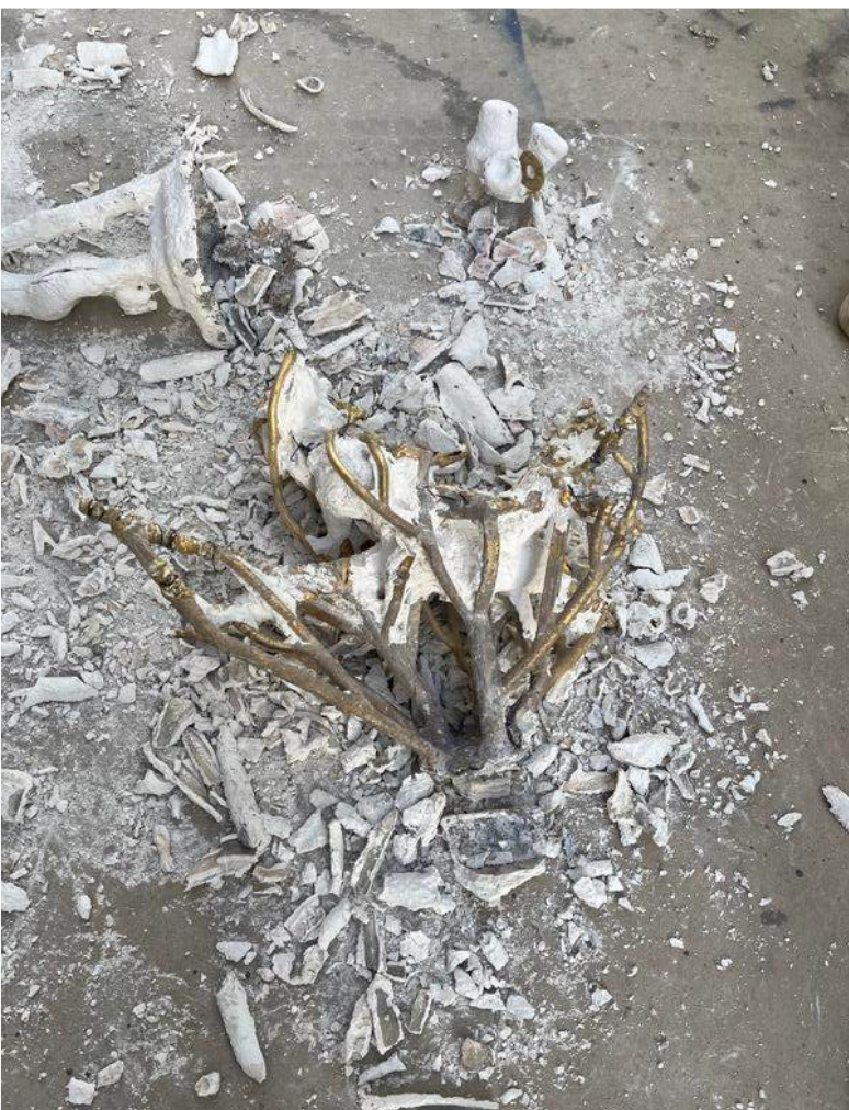
(Fig. 53) Eliminando todo los excedentes del molde.
