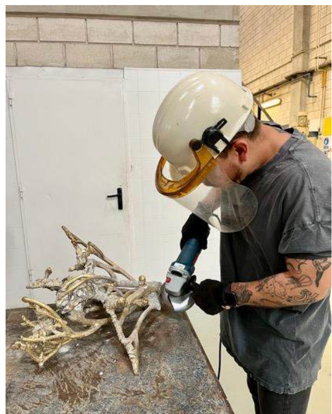
(Fig. 57) Puliendo zonas de la pieza con la radial.
