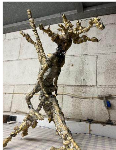
(Fig. 54) Lijando los excedentes de bebederos.
