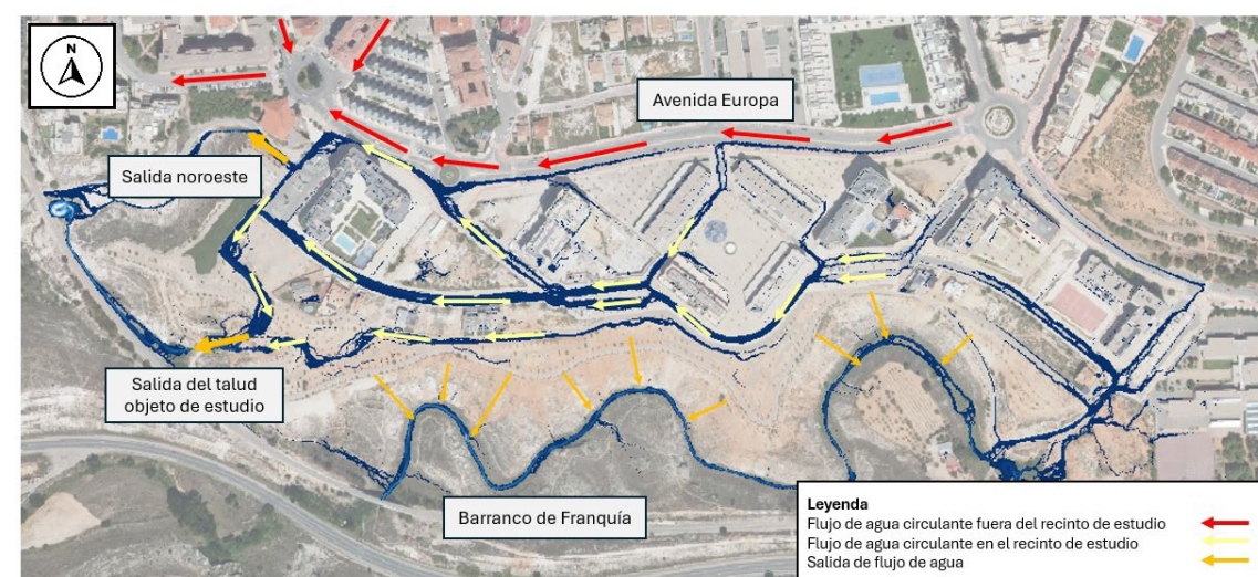
Figura 2.7. Dirección de los flujos del agua en el entorno del parque “Polígono Sur”. Fuente: elaboración propia a partir de cartografía a escala 1:50 procedente del Instituto Geográfico Nacional (IGN).
