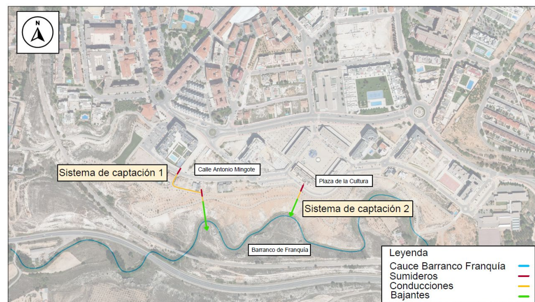
Figura 16. Ubicación de conducciones y bajantes en el terreno. Fuente: elaboración propia a partir de cartografía a escala 1:4.000 procedente del Instituto Geográfico Nacional (IGN).
