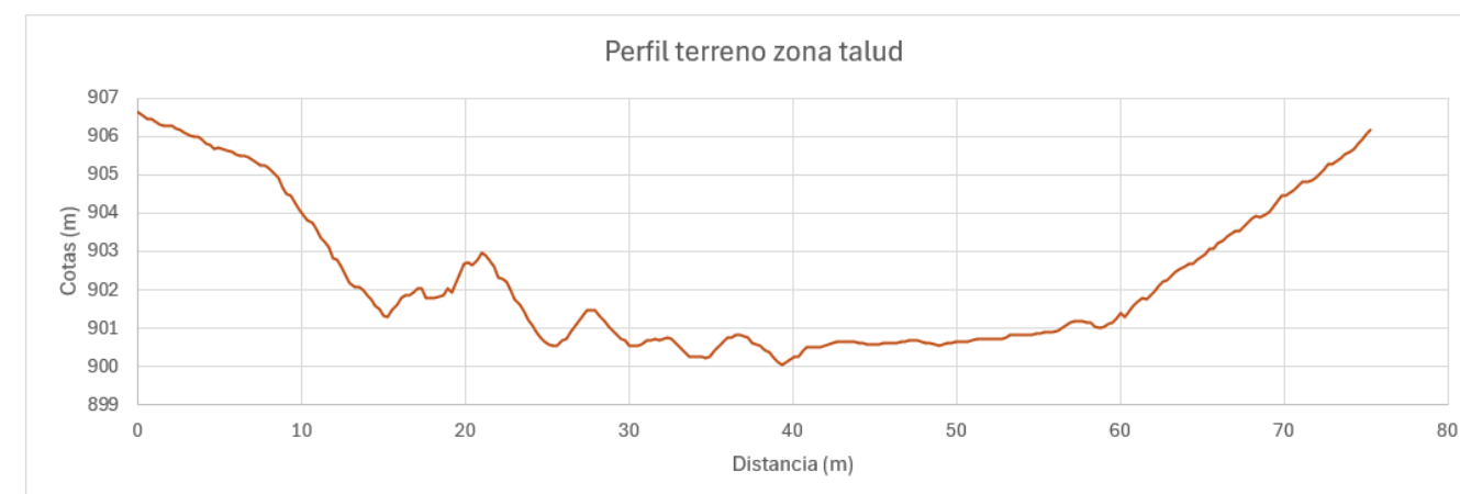
Figura 22. Perfil del terreno de la zona del talud objeto de estudio. Fuente: elaboración propia a partir de los datos extraídos del programa QGIS.
