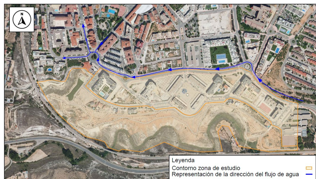
Figura 2.1. Delimitación del contorno de la cuenca del parque “Polígono Sur”, así como el esquema conceptual del movimiento de escorrentía superficial. Fuente: TURIVING S.A.
