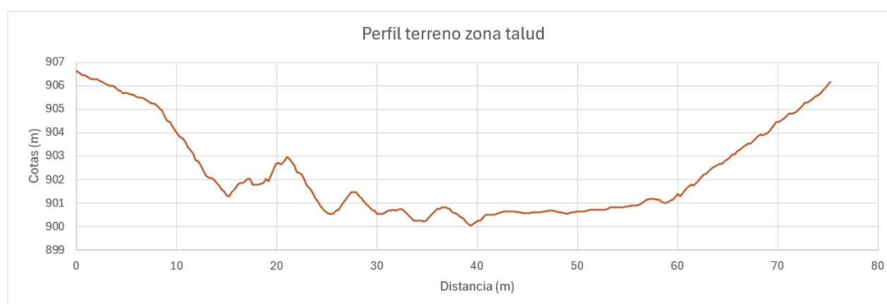
Figura 4.2. Perfil del terreno de la zona del talud objeto de estudio. Fuente: elaboración propia a partir de los datos extraídos del programa QGIS.
