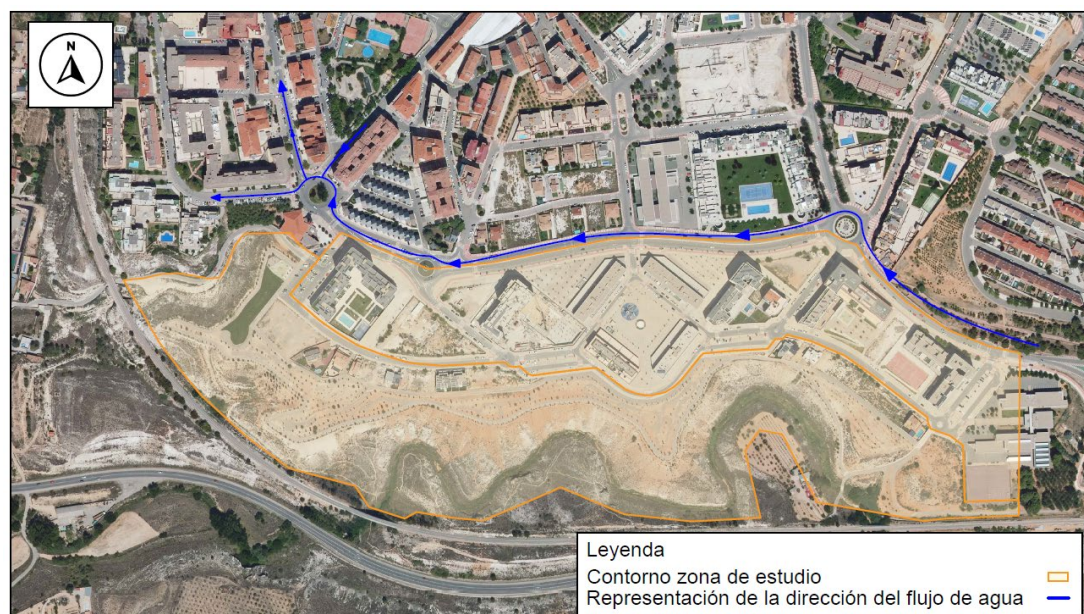
Figura 9. Delimitación del contorno de la cuenca del parque “Polígono Sur”, así como el esquema conceptual del movimiento de escorrentía superficial. Fuente: elaboración propia a partir de cartografía a escala 1:4.000 procedente del Instituto Geográfico Nacional (IGN).
