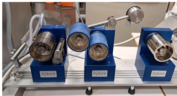
Figura 23: Línea de film pro CFPL 65 de Xplore.
