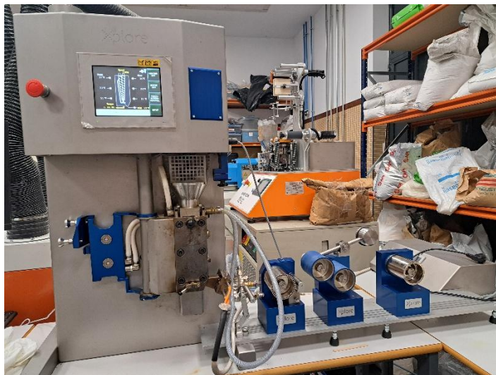
Figura 24: Montaje parte experimental para la extrusión y obtención de film.
