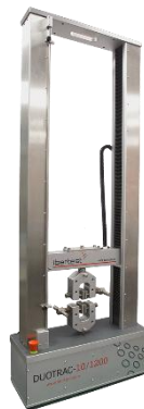
Figura 26: Máquina de ensayo universal con mordazas neumáticas.
