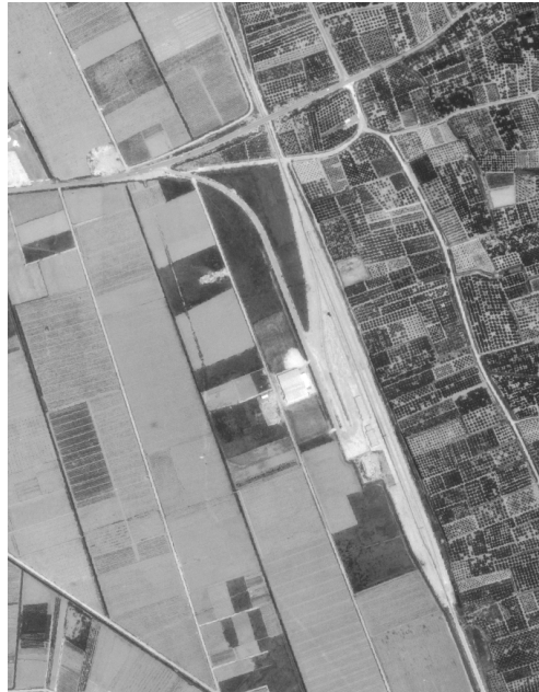
VUELO 1975 - Aparecen las vías del tren en construcción, la estación, la casa del guardia y una nave asociada al complejo. Además se aprecia el cambio topográfico de la desecación de la zona de marjal para cultivo y el nuevo sistema de acequias.
