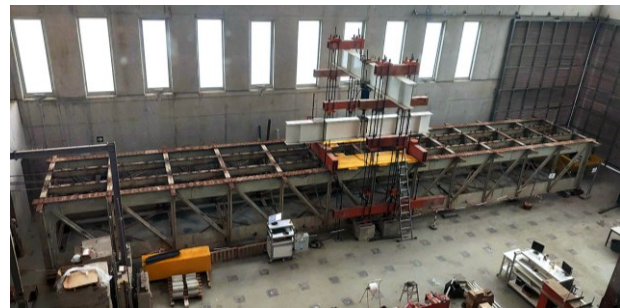
Fig. 2.32 Segmento del puente real ensayado en (Buitrago et al., 2021).
