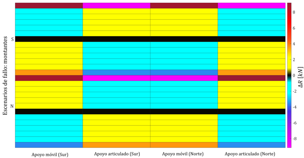
Fig. 4.64 Cambios en las reacciones verticales, en kN, correspondientes a los escenarios de fallo de los 26 montantes, entre los estados con daños y sin daños. El eje vertical representa la ubicación del montante eliminado, mientras que el eje horizontal muestra el apoyo para el cual se evalúa la reacción vertical en cada uno de los escenarios de fallo.
