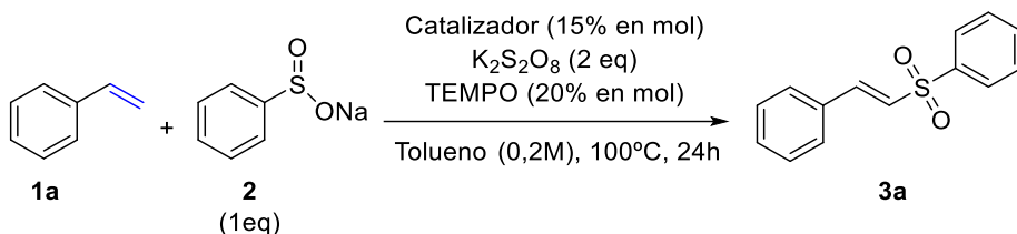
Figura 4.1. Condiciones de reacción para la formación de vinilsulfonas ( 3 ).
