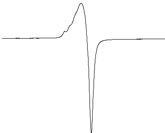
Figura 4.14. Espectro de EPR de Cu-NaUSY calcinada. Los parámetros hiperfinos son: g_{\parallel}=2,39 G y A_{\parallel}=122 G, valores que concuerdan con especies de \text{Cu}^{2+} .
