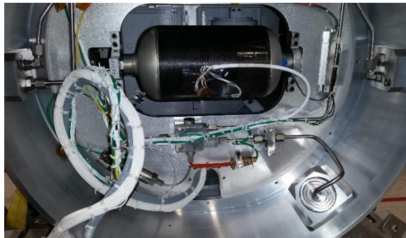
Figura 14: COPV integrado en la estructura de un lanzador suborbital (NASA)
