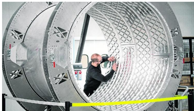
Figura 54: Comprobación de espesores en metrología (PLDSpace)
