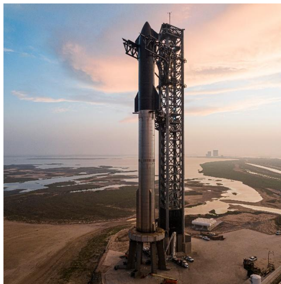
Figura 12: Cohete principalmente fabricado en acero (Starship, SpaceX)
