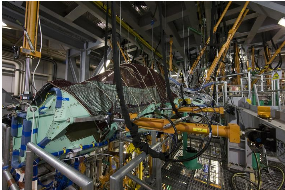
Figura 28: Ensayo de fatiga de un F-35 (BAE)
