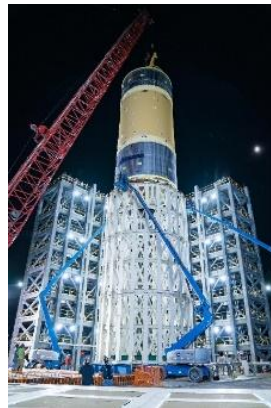
Figura 20: Tanque de la SLS en un banco de ensayos (NASA)
