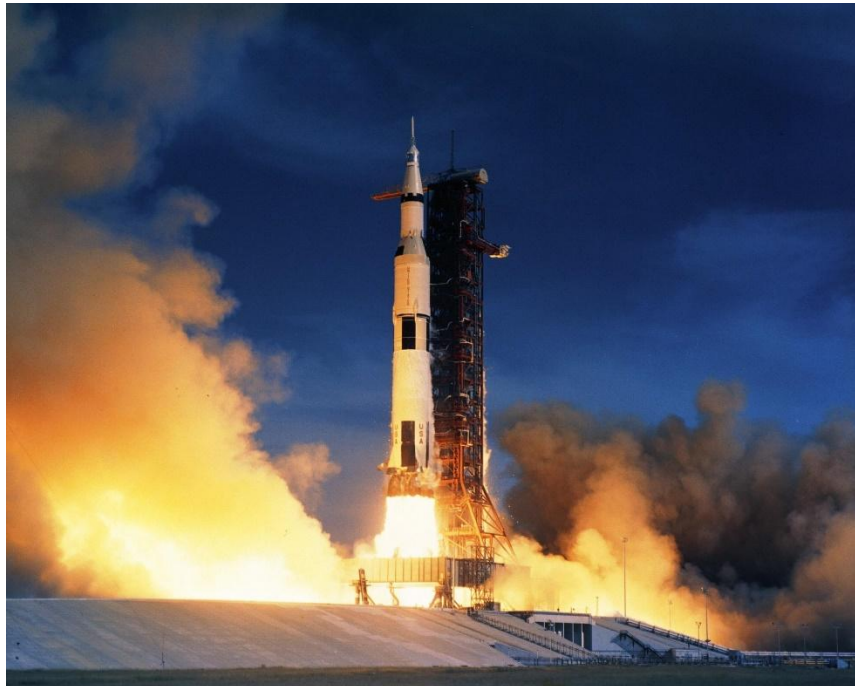
Figura 11: Cohete principalmente fabricado en aluminio (Saturn V, NASA)
