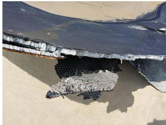
Figura 16: Delaminación de fibras de un cohete y vista del honeycomb (SpaceX)
