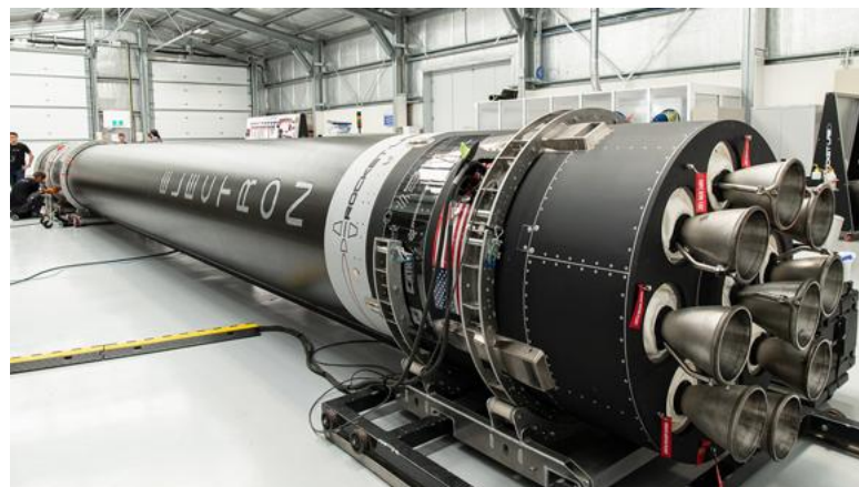
Figura 13: Cohete fabricado principalmente en CFRP (Electron, RocketLab)
