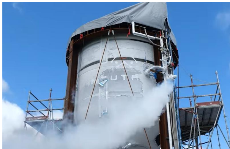
Figura 10: Tanque del lanzador Neutrón llevado a condiciones criogénicas (RocketLab)
