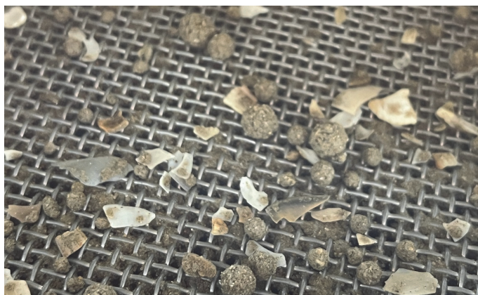
Fig. 3. Ejemplo de un intento de tamizado de una muestra de arena que no está suficientemente seca. Las vibraciones de la máquina tamizadora crean esferas compactas con los granos de arena. También se puede apreciar visualmente cómo la humedad en la arena crea obstrucciones en los poros de la rejilla de cada tamiz.
