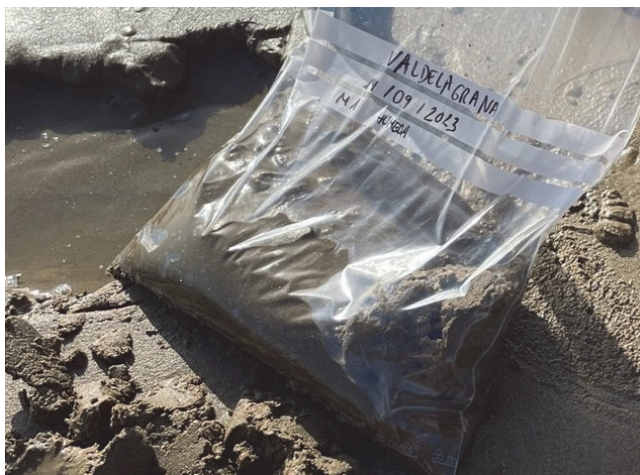
Fig. 2. Bolsa de muestra con 800 gr de arena con un poco de exceso de agua. Para cada playa se recopilaban 10 bolsas de muestras como la de esta figura. Cada bolsa de muestra se dividió posteriormente en 5 submuestras: 130 gr para secar en mufla, 130 gr para secar a cada una de las potencias del microondas (700w, 595w, 462w, y 300w), y 150 gr extra por si ocurriese una posible pérdida.
