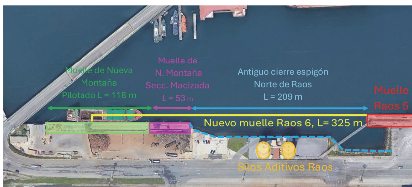
Fig. 3. Planta instalaciones existentes. Fuente: elaboración propia. (2023)
