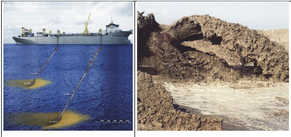
Fig. 1. Vista de una draga de succión en marcha con el brazo extendido (izq.) y del vertido de la mezcla de arena y agua en la playa (der.)
