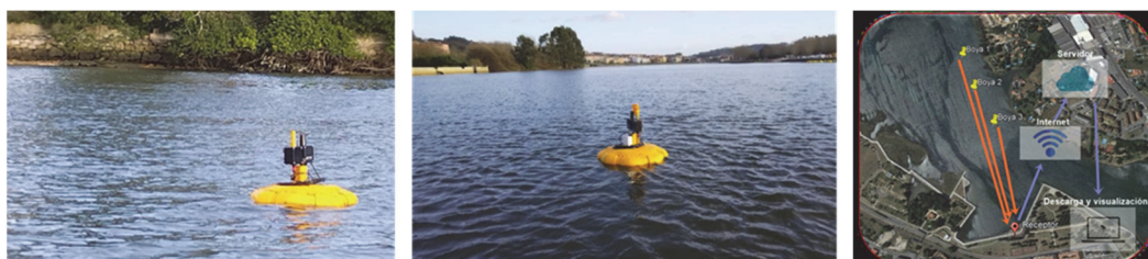
Fig. 9. Boyas con sensores de turbidez en continuo. Fuente: Seguimiento audiovisual del proyecto.
