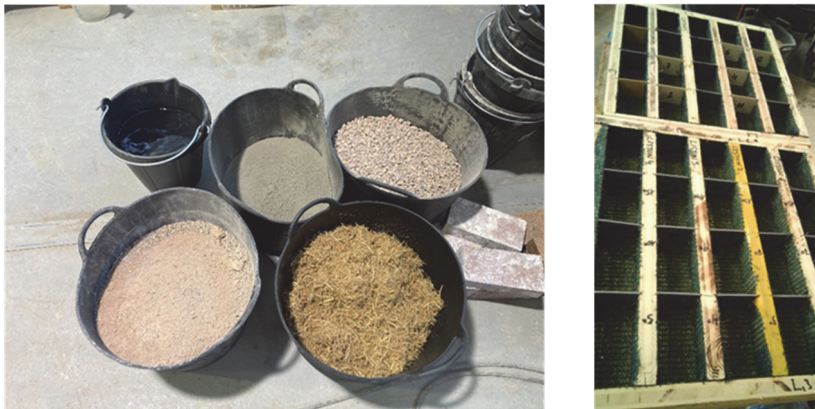
Fig. 4. Materiales empleados con FPA (izq.) y moldes con acabado rugoso (der.). Fuente: UJI
