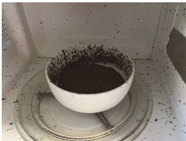
Fig. 4. Vista del interior del microondas después de que una muestra de arena explotase durante el proceso de secado en microondas.
