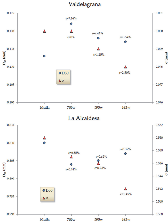
Fig. 7. Parámetros D_{50} y sorting ( \sigma ), con el error ( \epsilon ) para cada potencia de microondas, tomando como valor de referencia el resultado de la mufla (para las playas de ValdelaGrana y La Alcaldesa).
