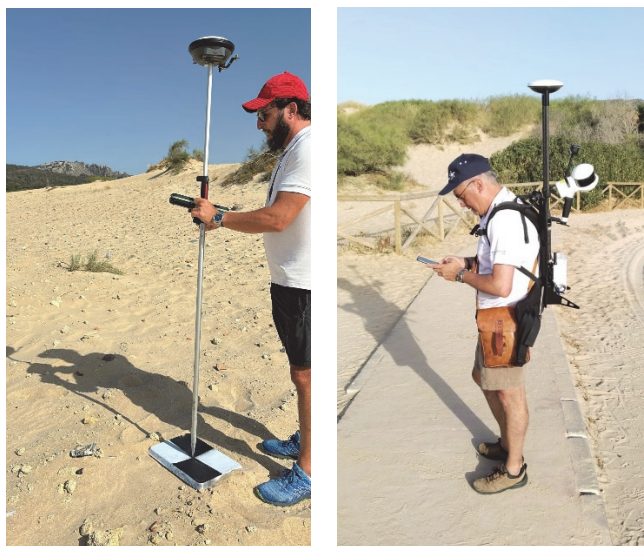
Figura 2. (A) Imagen de la toma de datos con GPS. (B) Imagen de la toma de datos con escaner 3D
