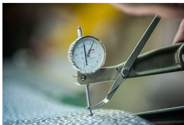
Figura 74. Medición con micrómetro. Taller Desmottes.
