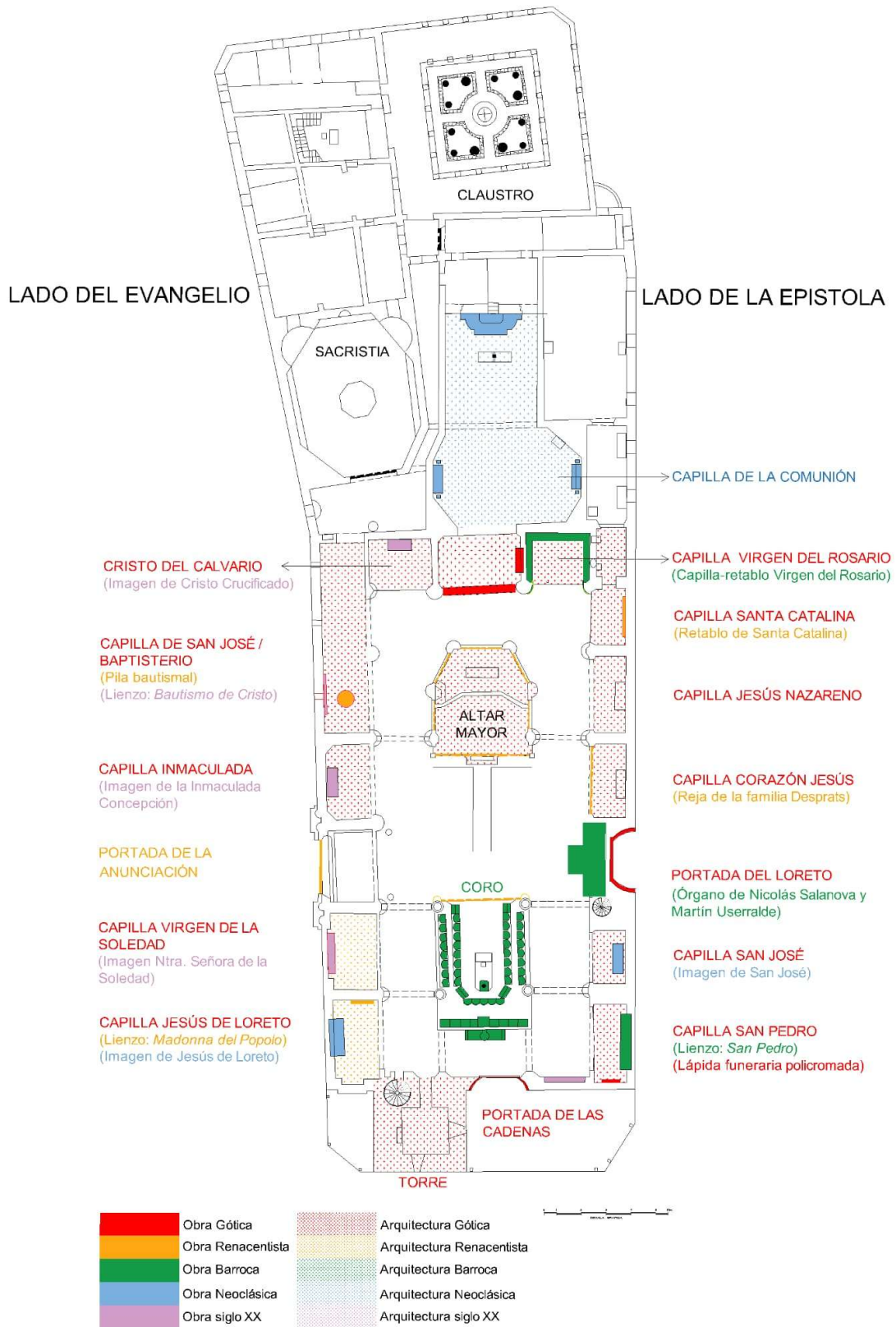
Figura 25. Planta de la Catedral de Orihuela con AutoCAD, 2025. Elena Valbuena Miralles.
