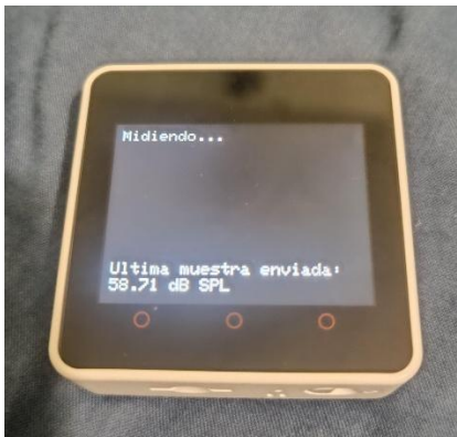
Figura 23: M5core2 con la conexión a servidor local
