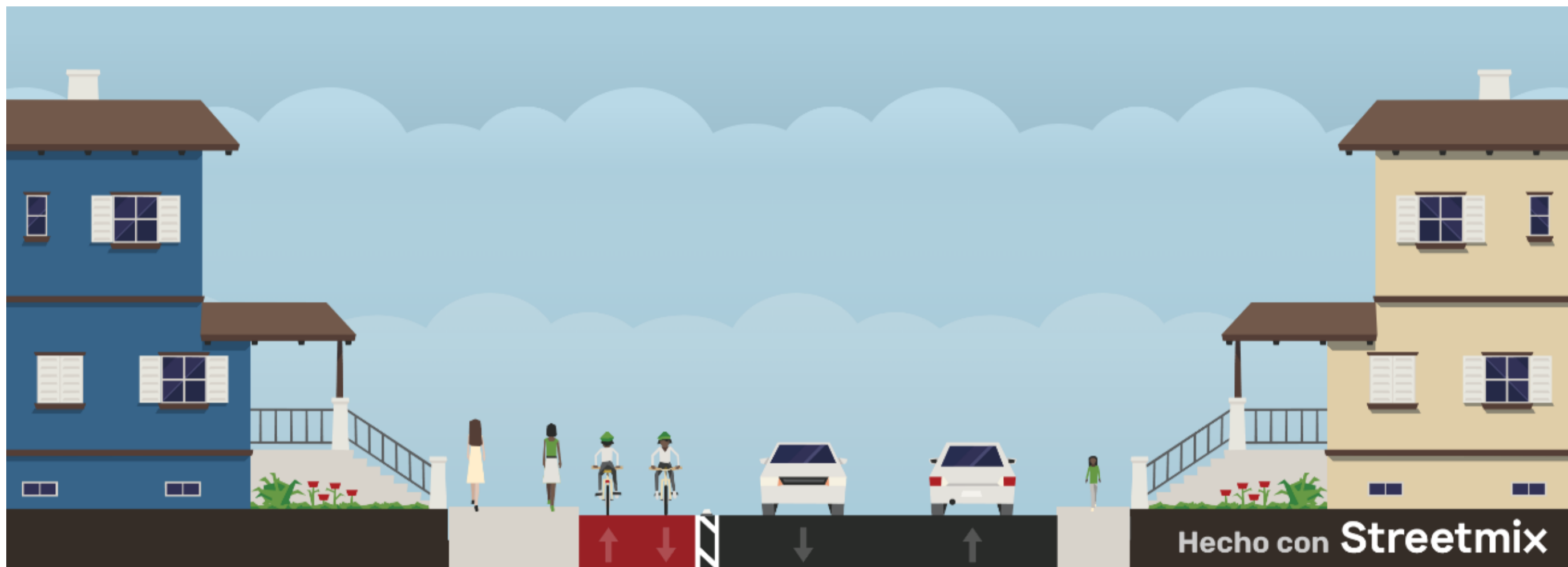
Ilustración 72. Perfil transversal propuesto como alternativa 1 para la vía que pertenece al grupo III. Elaboración propia.
