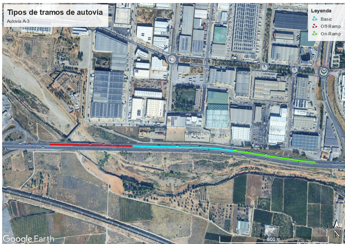
Figura 21 Tipos de tramos de autovía, ramales de entrada y salida (Fuente Elaboración propia)
