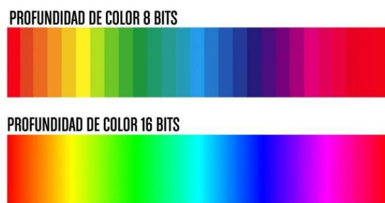
Il·lustració 26 Varietat de colors en un sistema de 8 bits respecte d'un de 16 bits.
