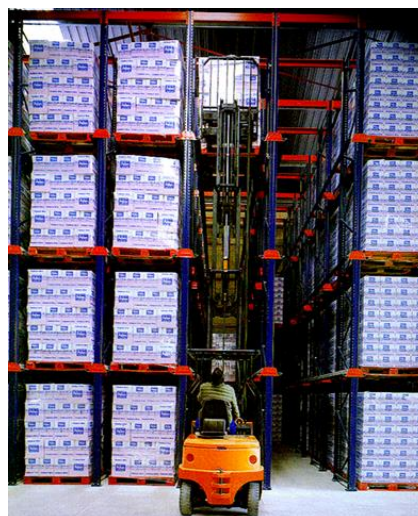
Ilustración 14: Estanterías compactas (Fuente: Cardós Carboneras, 2020)
