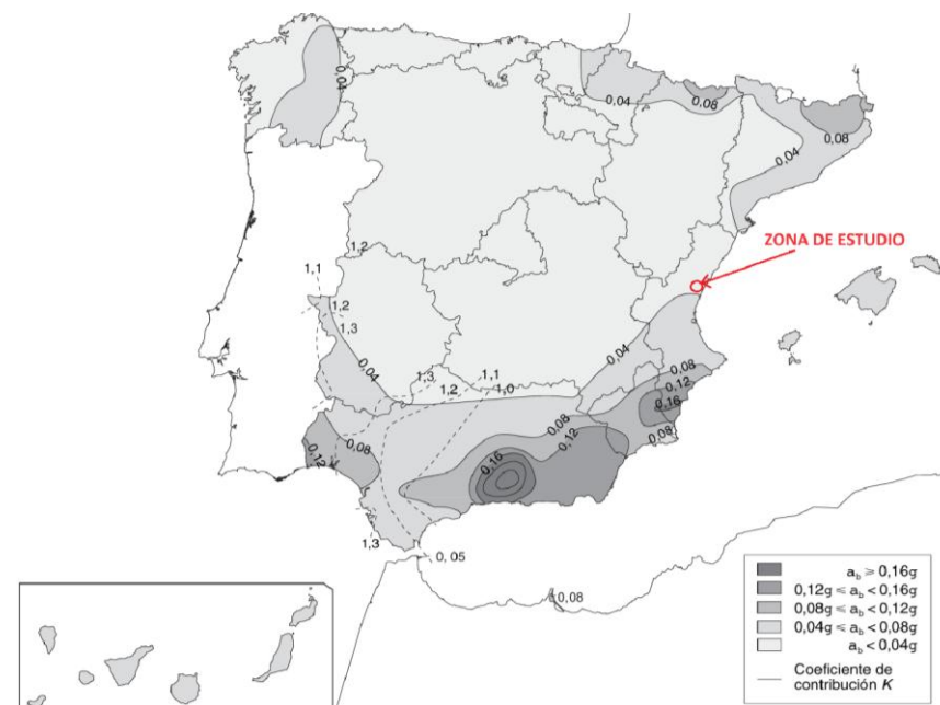
Ilustración 3. Mapa de peligrosidad sísmica. Fuente: NCSP 07
