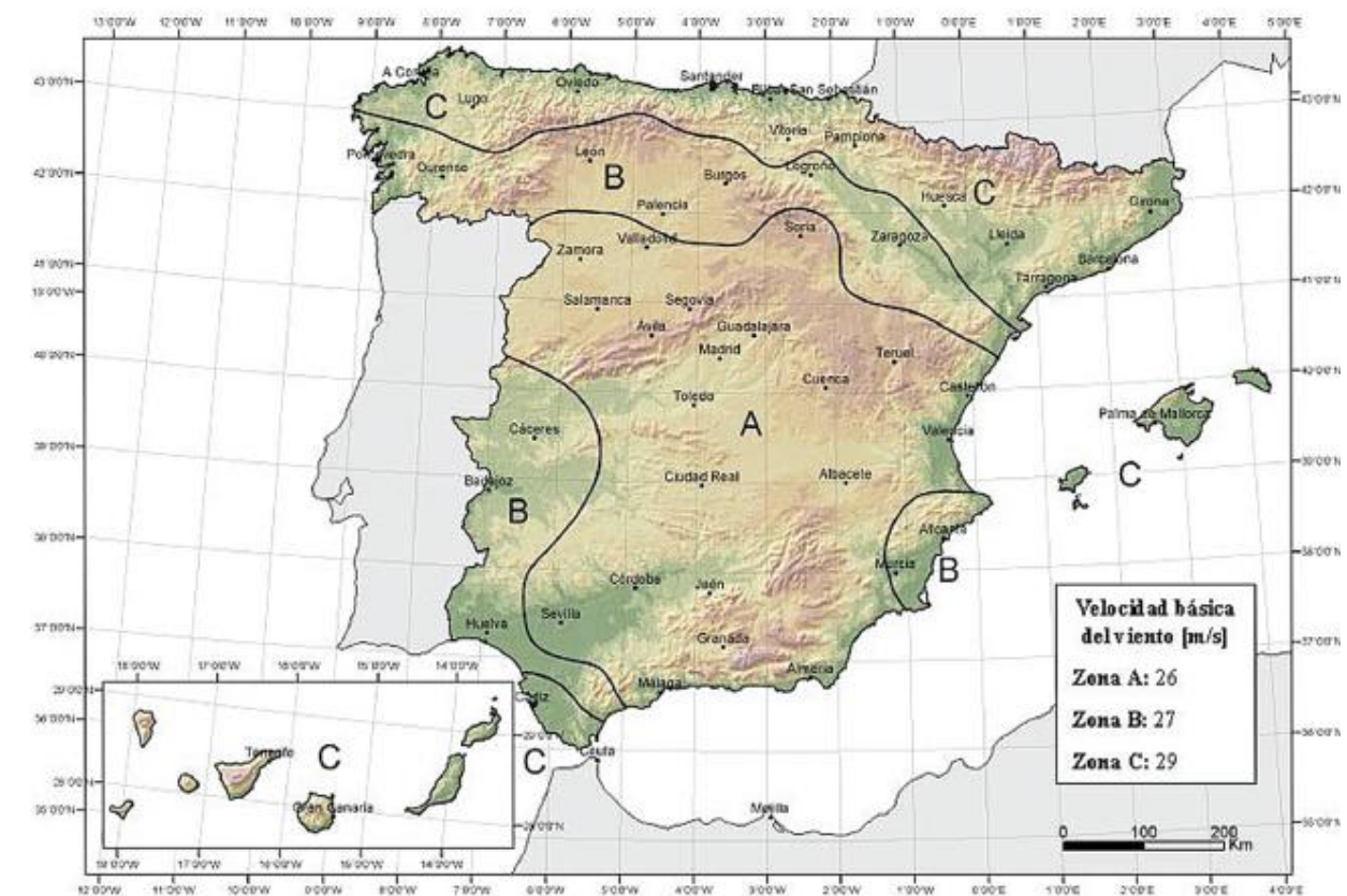
Ilustración 1. Mapa de isostáticas para la obtención de la velocidad básica fundamental del viento v_{b,0} . Fuente: IAP 11
