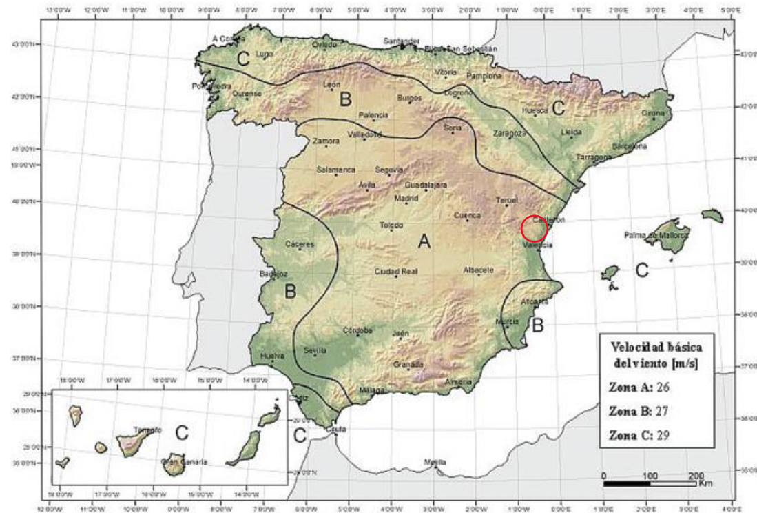
Ilustración 2. Mapa de isostáticas para la obtención de la velocidad básica fundamental del viento v_{b,0} . Fuente: IAP 11
