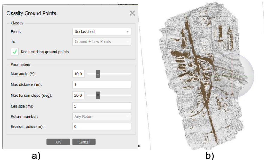
Figura 17: a) Parámetros de clasificación de nube de puntos. B) Clasificación de nube de puntos por la clase Ground (Fuente: elaboración propia).
