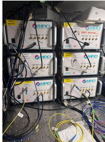
(b) MPD PDM-IR SPAD.
