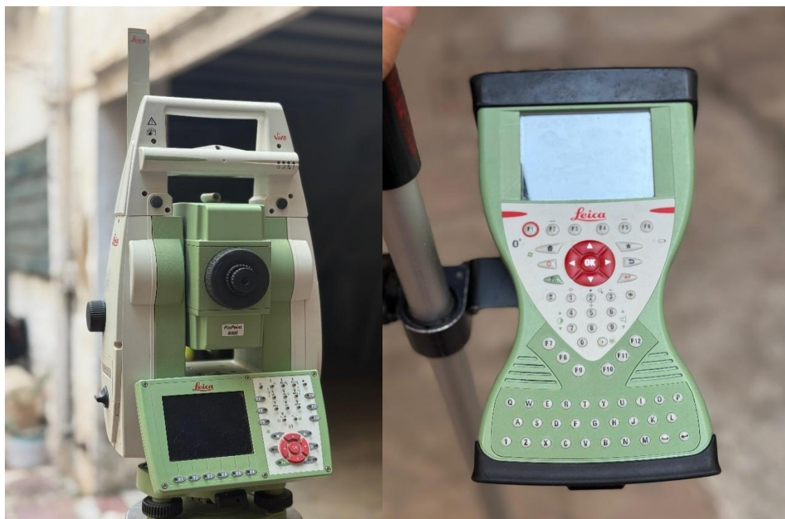
Figura 10.1. Estación total Leica TS15 y libreta CS15. Elaboración propia.
