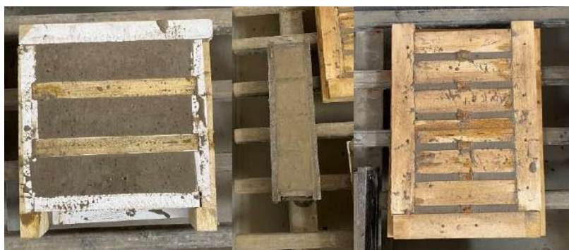
Ilustración 36. Elaboración de las probetas de GPP+SF
