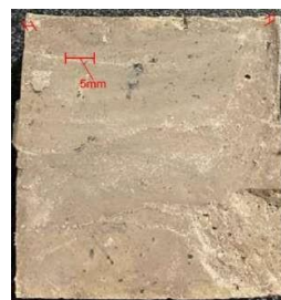
Ilustración 68. Registro fotográfico de la profundidad de corrosión en probetas prismáticas sumergidas con ácido durante 120 horas y probetas cúbicas atacadas agresivamente por 61 días.
