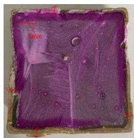
Ilustración 68. Registro fotográfico de la profundidad de corrosión en probetas prismáticas sumergidas con ácido durante 120 horas y probetas cúbicas atacadas agresivamente por 61 días.
