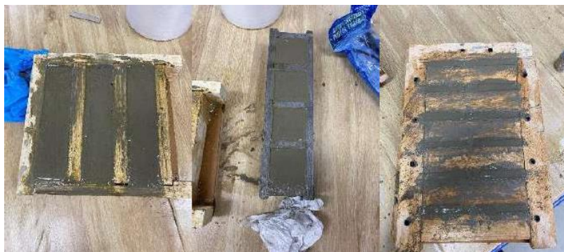
Ilustración 35. Elaboración de las probetas de CP.
