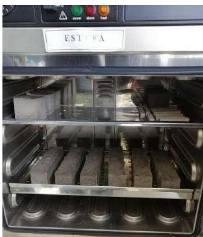
Ilustración 37. Curado de las probetas de GPP+SF en el horno.
