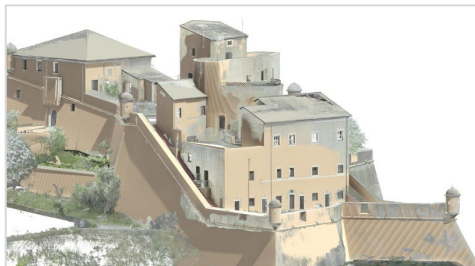
Fig. 5- Modello BIM sovrapposto alla nuvola di punti di Forte San Giovanni (elaborazione grafica a cura di Fabrica srl, 2022).
