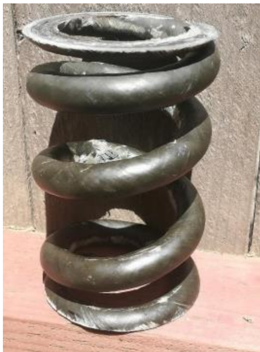
Ilustración 20. Muelle curado y con los extremos mecanizados (Jonathan K. Frank, 2020).
