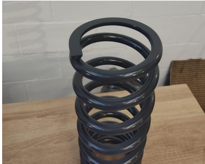
Ilustración 16. Extremo a escuadra y rectificado en el muelle de suspensión de un Range Rover modelo Classic.
