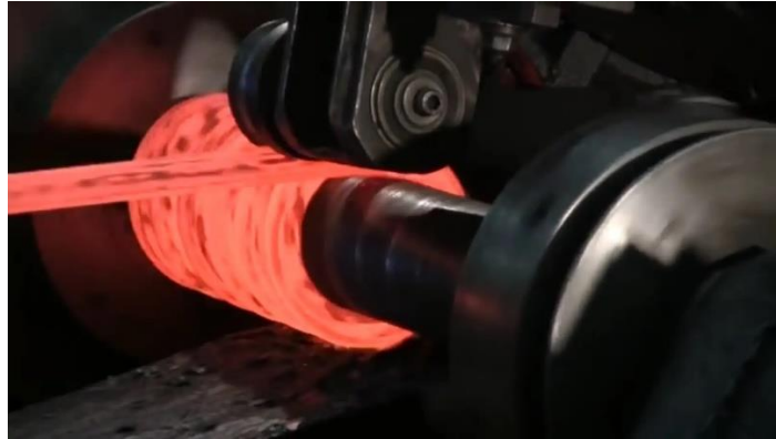
Ilustración 14. Fabricación en caliente de un muelle helicoidal mediante el mandril guía y la herramienta de corte.
