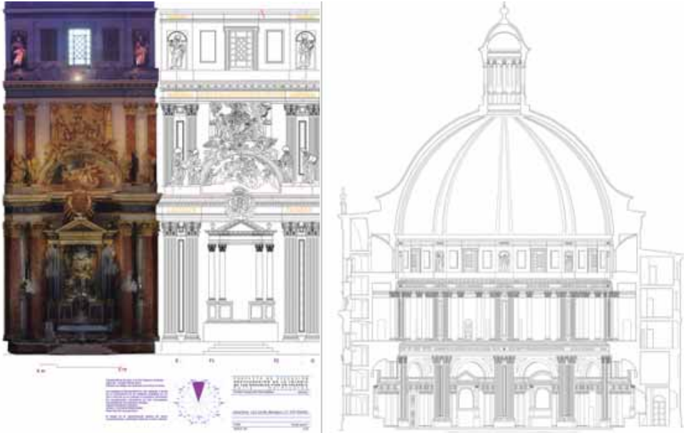
Levantamiento fotogramétrico del proyecto arquitectónico y dibujo en CAD, revisando y completando la documentación del Plan Director del Monumento. Rilievo fotogrammetrico del progetto architettonico e disegno in CAD, rivedendo e completando la documentazione del Piano Direttore del Monumento. Photogrammetric survey of the architectural project and its drawing in CAD, reviewing and completing the documentation of the Monument Master Plan. Relevé photogrammétrique du projet architectural et dessin en DAO, en vue de réviser et de compléter la documentation du Plan directeur du Monument.
