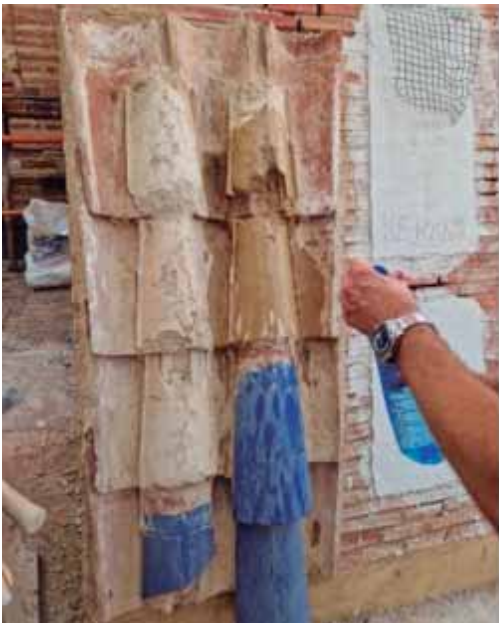
Maqueta a escala 1:1 para analizar los morteros, la colocación de las tejas sobre el soporte, etc., y un estudio de las plomadas de la cúpula / Modello in scala 1:1 per analizzare i mortai, la posa delle tegole sul supporto, ecc., e studio delle linee a piombo della cupola / 1:1 scale model to analyze mortars, tile placement on the support, etc., and a study of the dome's plumb lines / Maquette à l'échelle 1:1 pour analyser les mortiers, la pose des tuiles sur le support, etc., et étude des fils à plomb du dôme.
