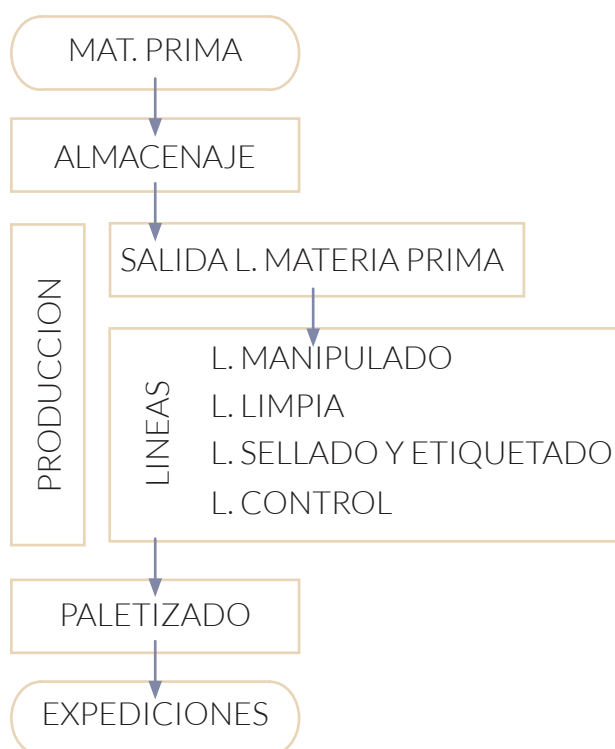
Figura 39. Diagrama de flujo envasado de pescado
