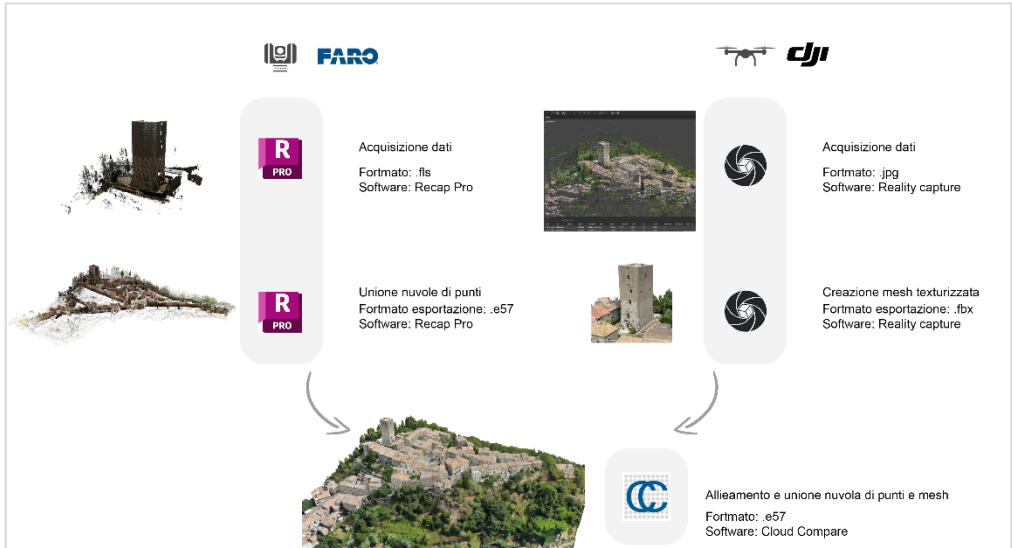
Fig. 3- Workflow relativo alla metodologia del rilievo integrato (elaborazione degli autori, 2024).
