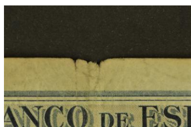
Fig.22 Detalle del rasgado superior causa del pliegue vertical
