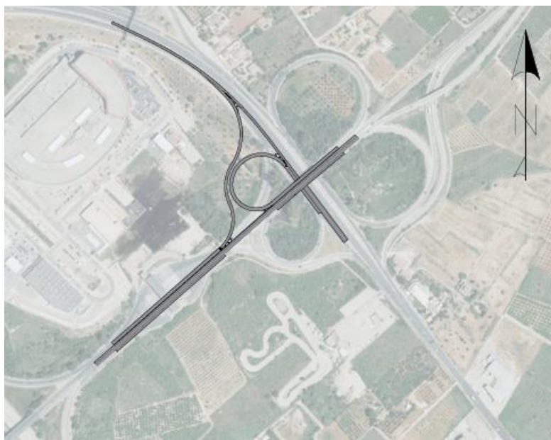
Figura12. Esquema trébol completo y carriles de trenzado. Fuente: elaboración propia
