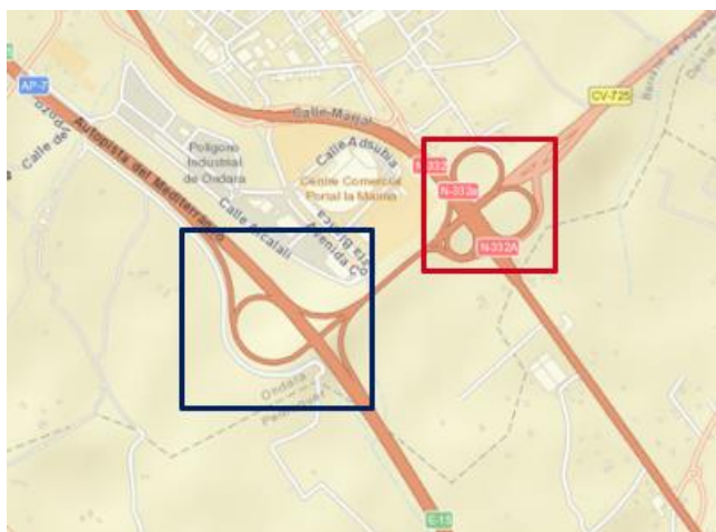
Figura 10. Situación actual de los dos enlaces de la CV-725, marcado en azul el enlace tipo trompeta y en rojo el trébol parcial. Fuente: elaboración propia
