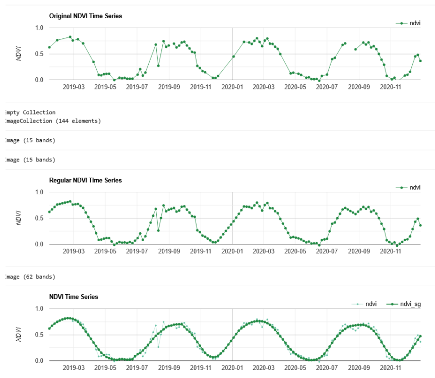
Figura 23: Grafica del filtro Savitzky-Golay (Fuente: Generada por código abierto de GEE https://code.earthengine.google.com/ffd0b9b3c372d5e21181a6144acb0ae3 )
