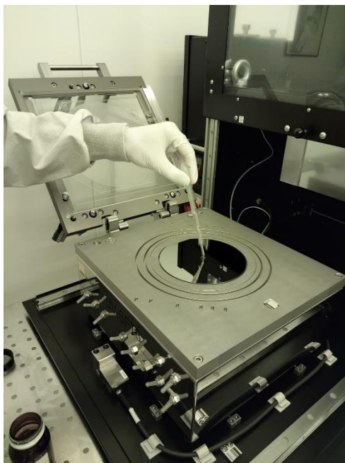
Figura 22. Deposición de la resina sobre el máster. El foil ya está en posición sujeto con vacío
