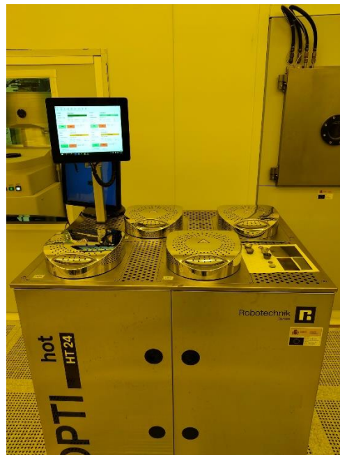
Figura 31. Hotpates utilizados en la curación de las diversas resinas
