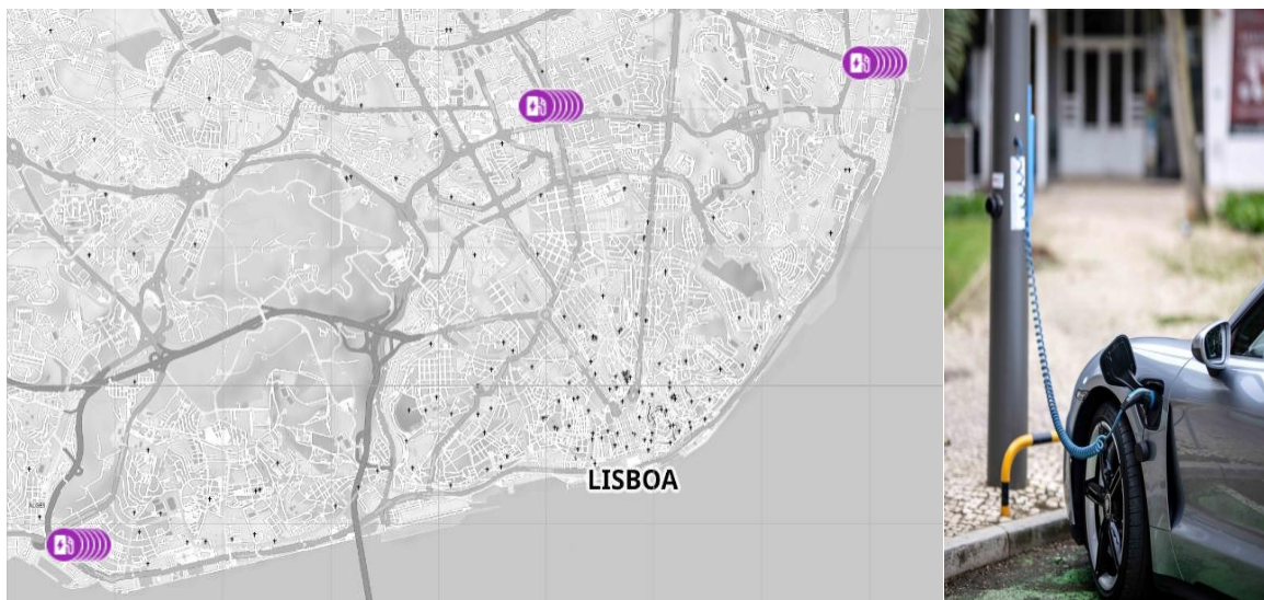
Ilustración 6. Islas de carga rápida en Lisboa y puntos de carga en farolas
