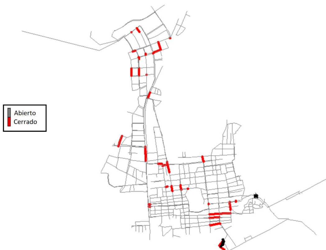
Figura 4.24. Resultado del algoritmo para el análisis de los límites de cada DMA.
