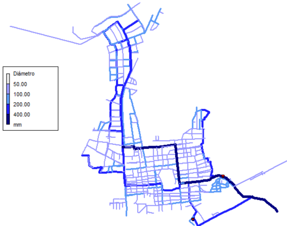
Figura 4.18. Cierre de tuberías en el sector 10 y configuración de las PRV.
