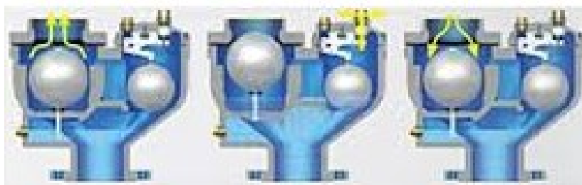
Figura 5. Combinación de una válvula de gran orificio con un purgador [13].
