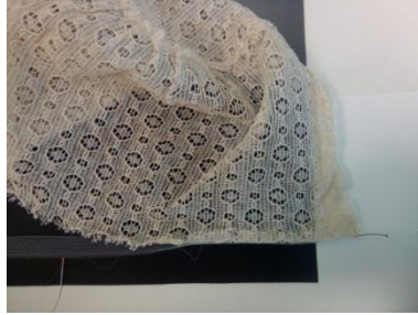
Figura 33. Fotografía del encapsulamiento mediante monofilamento del tejido base del G2.
