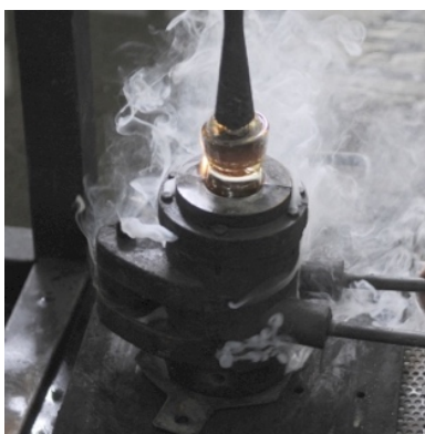
Fig. 44. Introducción de la burbuja de vidrio en el molde
