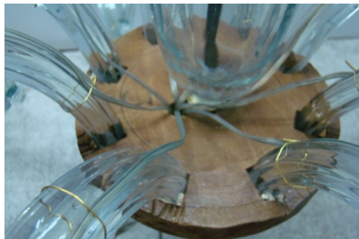
Fig. 113. Detalle del cableado de los brazos
