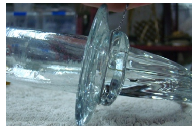
Fig. 84. Colocación del alambre
