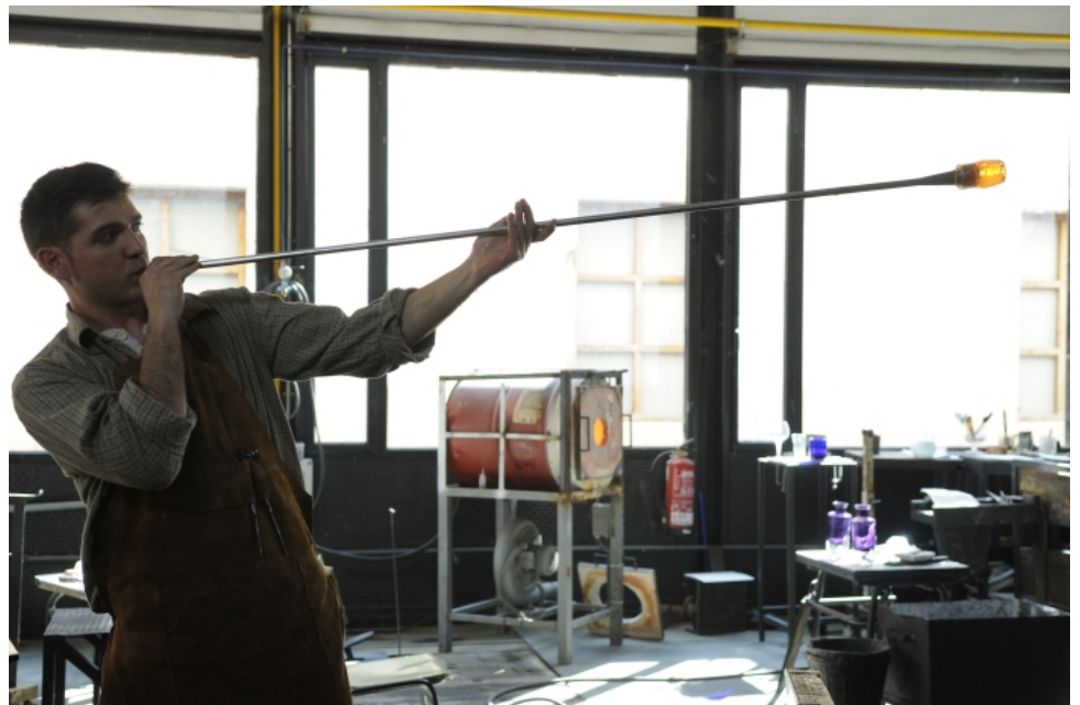
Fig. 43. Soplado del vidrio a través de la caña
