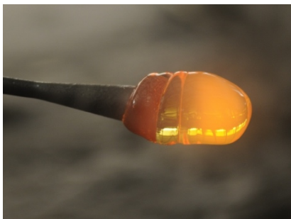
Fig. 42. Toma de vidrio caliente
