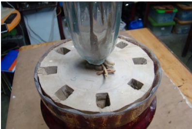
Fig. 59. Detalle de los orificios del repartidor
