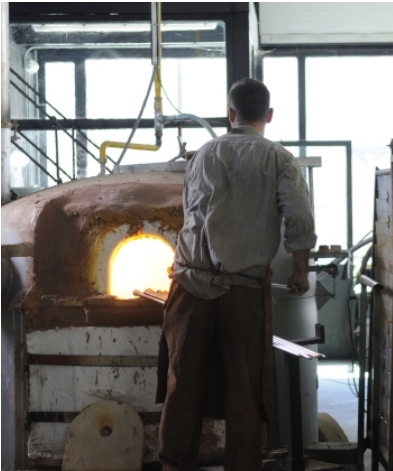
Fig. 41. Extracción del vidrio caliente
