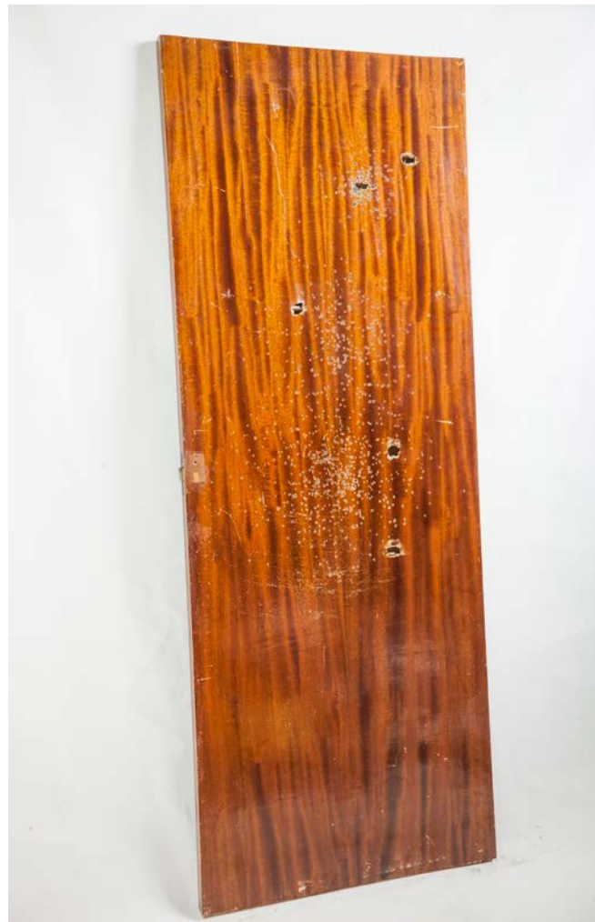
Puerta 1. De chapa con cámara de cartón en el interior. 4 disparos de escopeta
