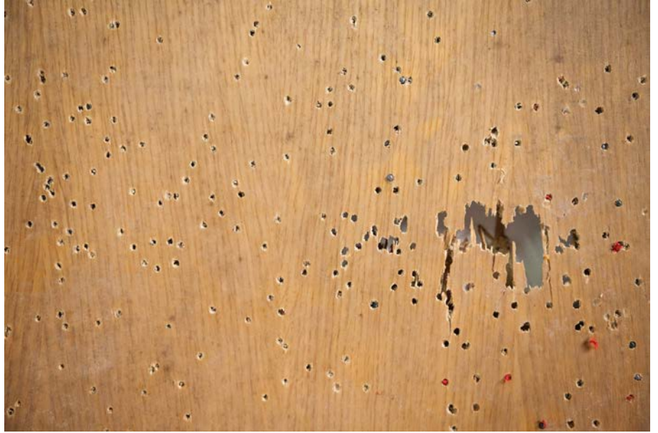
Detalle puerta 3. Puede apreciarse cómo algunos perdigones se quedan en la superficie, al ser madera más robusta.
