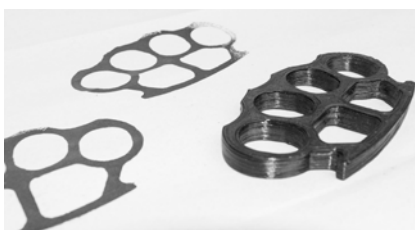
Fig.20 y 21 Detalles de las matrices fabri- cadas con impresora 3d. Tipografía y puño americano.
