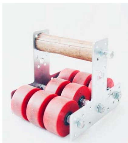
Fig.16 Estampador manual fabricado para imprimir el proyecto. Estructura de acero 16cm largo X 15cm ancho X 15cm altura Ruedas de plástico rígido de 2,6 cm de ancho
