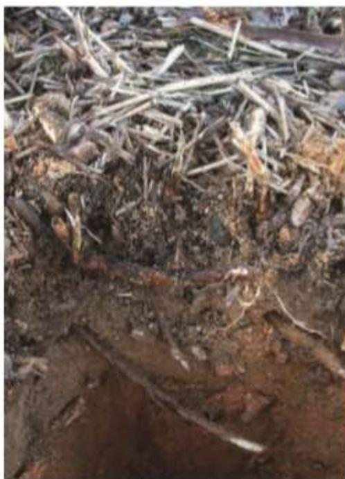
*Figura 64. Penetración de los rizomas en el sustrato (aproximadamente 30cm.) tras cinco años de operación. Planta experimental de Carrión de los Céspedes. Tomado de (Salas Rodríguez, 2007)*
