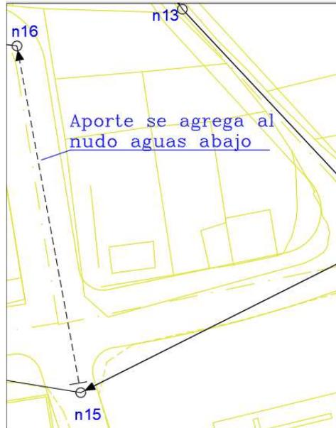
Figura 27. Detalle simplificaciones realizadas en la red.
