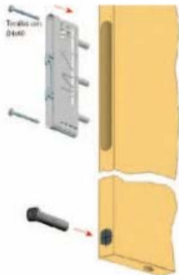
Tope de bloqueo Antidescolgamiento con 3mm de recorrido.
